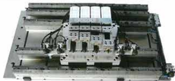
Morsa verticale con inserimento di pallet di morsa da ripresa
