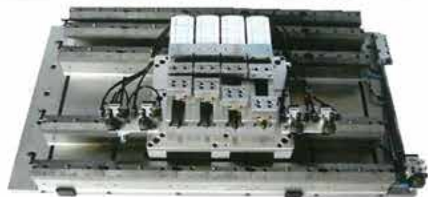
Morsa verticale con inserimento di pallet di morsa da ripresa
